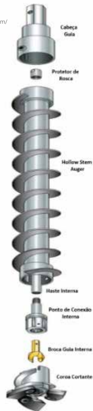
Figura 5.28. Componentes da perfuração da hollow stem auger.
