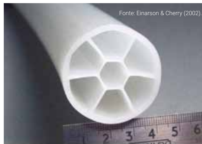
Figura 5.30: Seção CMT com sete compartimentos.
