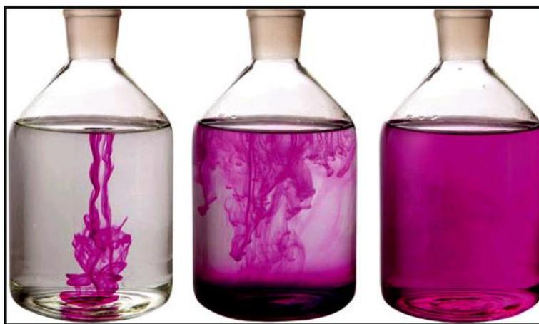
**Fotografia 3** - Exemplo de difusão de permanganato de potássio em água
