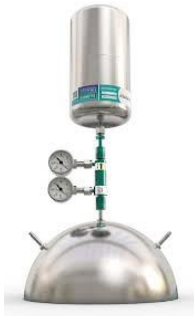
Figura 1 - Câmara de fluxo estática com canister acoplado na porta de amostragem, pronto para coleta.
